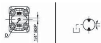
Drainage extérieur - Code E
