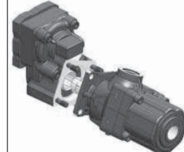
1 - Monter la pompe sur la PTO avec le joint d'étanchéité si inclus avec le kit de montage.
