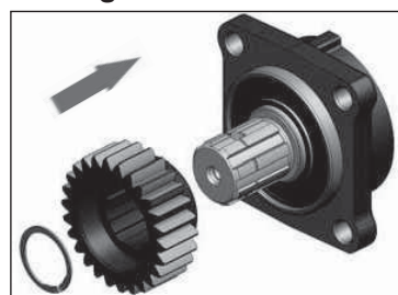
1 - Montez l'engrenage fourni sur l'arbre de la pompe et fixer le avec un Circlip.
