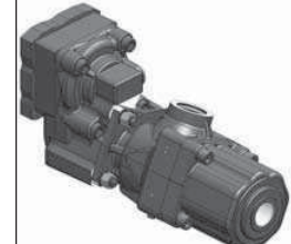
4 - Pousser la pompe contre la PTO et serrer complètement les écrous. Couple de serrage comme dans le TABLEAU 3 Chap.3.
