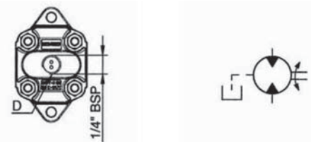
Drainage extérieur - Code E
